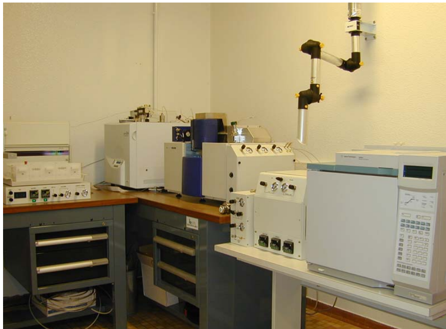
Figure III-7 : Spectromètre de masse de type IRMS (Isotope Ratio Mass Spectrometer de marque Isoprime, GV Instrument, Manchester, Royaume-Uni) couplé à un analyseur élémentaire C/N/S (EA3000, Eurovector, Milan, Italie) utilisé pour déterminer les teneurs en N et C, et le niveau de marquage en ^{15}\text{N} dans les différents tissus de colza.
