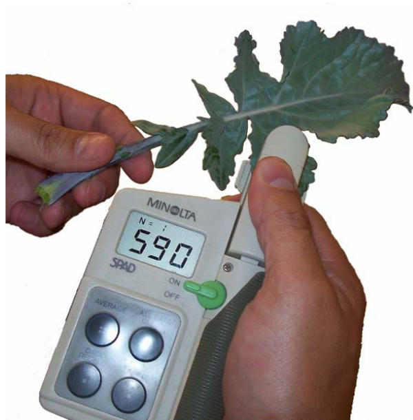
Figure III-6 : SPAD (Soil Plant Analysis Development) (Minolta), appareil permettant de mesurer les teneurs relatives en chlorophylles. Deux faisceaux (rouge et infrarouge) sont émis par la pince qui séquestre la feuille. Les faisceaux traversent la feuille et sont captés par la cellule réceptrice. L'énergie photonique est convertie en signal numérique. Le ratio des intensités de lumière rouge (650 nm, absorbée partiellement par les chlorophylles) et infrarouge (>800 nm, non absorbée) permet de définir une teneur relative en chlorophylles (unité SPAD).
