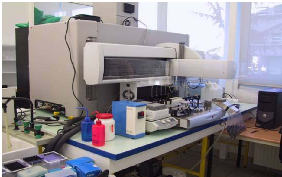
Figure III-13 : Digesteur automatique (MultiPROBE II, PerkinElmer) de la plateforme protéomique de Rouen utilisé pour la digestion trypsique des protéines.
