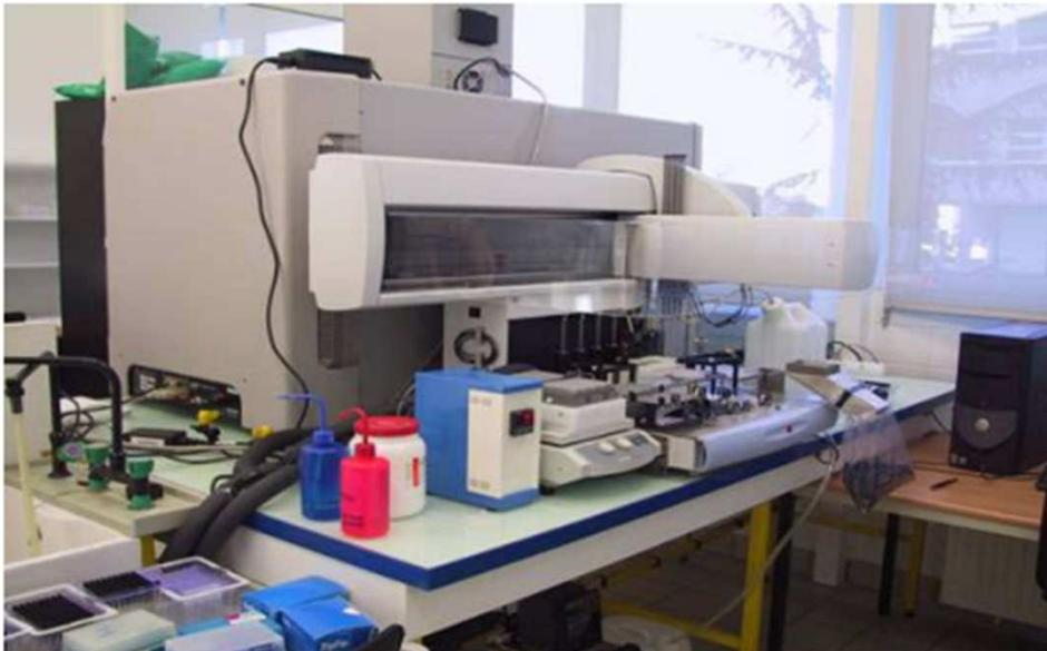
**Figure C-11 : Digesteur automatisé (MultiPROBE II, PerkinElmer) de la plateforme protéomique PISSARO de Rouen utilisé pour la digestion trypsique des protéases mises en évidence par zymogrammes.**
