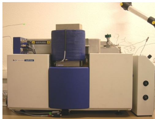
Figure III.5 Analyseur élémentaire C/N/S (EA3000, Eurovector, Milan, Italie) couplé à un spectromètre de masse de type IRMS (Isotope Ratio Mass Spectrometer de marque Isoprime, GV Instrument, Manchester, Royaume-Uni) utilisé pour déterminer les teneurs en N et S, et le niveau de marquage en 34 S dans les différents tissus végétaux.
